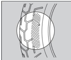
Inspeccione los neumáticos en busca de signos de desgaste anómalo en la superficie de contacto.
