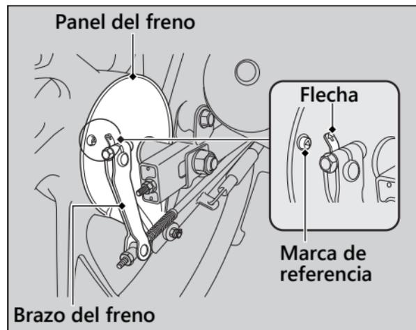
Cuando se acciona el freno, la flecha unida al brazo del freno se mueve hacia una marca de referencia en el panel del freno. Si la flecha se alinea con la marca de referencia al accionar el freno a fondo, es necesario reemplazar las zapatas de freno. Vaya a su concesionario para esta operación.
