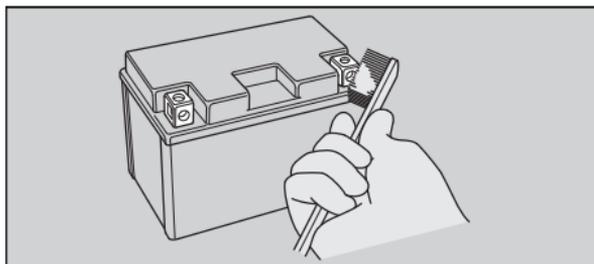
4. Tras la limpieza, vuelva a instalar la batería. La batería dispone de una vida útil limitada. Consulte con su concesionario el momento de sustituir la batería. Sustituya siempre la batería por otra batería exenta de mantenimiento del mismo tipo.
