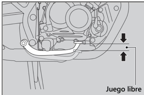
Asegúrese de que la varilla del freno, el brazo del freno, el muelle y el dispositivo de sujeción estén en buenas condiciones.
