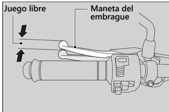
Compruebe que el cable del embrague no esté retorcido y que no muestre señales de desgaste. Si fuera necesario, haga que se lo cambien en su concesionario.
