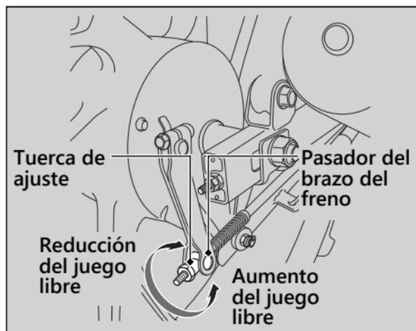
1. Realice el ajuste girando la tuerca de ajuste del freno trasero media vuelta cada vez.
