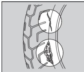
Compruebe la existencia de cortes, fisuras o grietas que expongan la tela o los hilos, o posibles clavos u otros objetos extraños incrustados en el lateral del neumático o en su banda de
