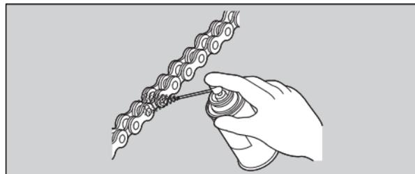
Nunca utilice gasolina ni disolventes de bajo punto de inflamación para limpiar la cadena de transmisión.
