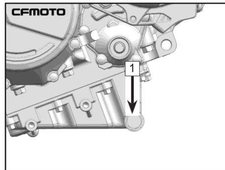
Coloque una bandeja de aceite debajo de la posición del perno de drenaje de aceite; Retire el perno magnético de drenaje de aceite y la arandela 1 ; Escurrir completamente el aceite usado;
